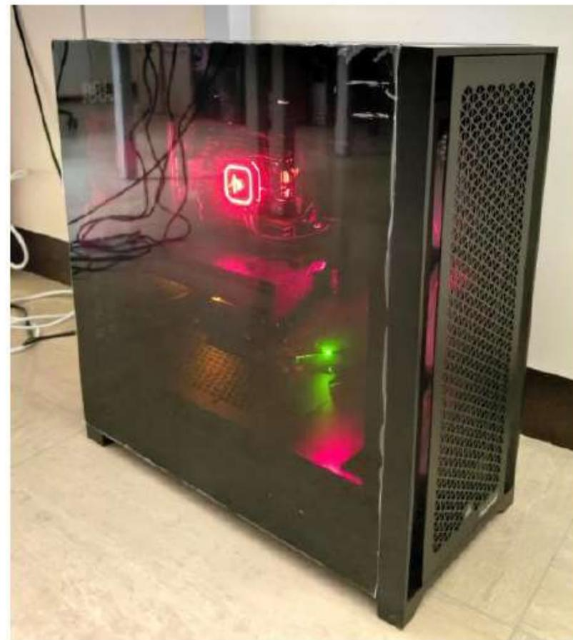
後処理計算機(64コアCPU、GPU NVIDIA)
